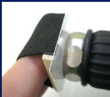
箔や透明な材料の場合、付属の小さなセラミックプローブをサンプル背面に配置し、近赤外光を検出部に反射させて、データ評価を向上させます。
